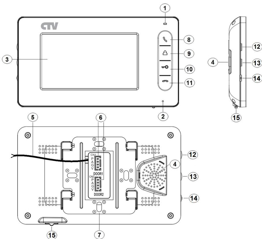
**Таблица №1 Конструкция монитора**
